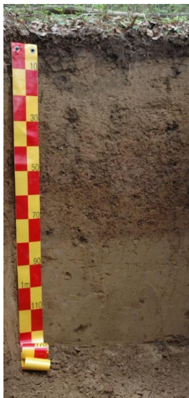
Figura 8.5: Perfil ideal del suelo. Tome siempre la foto perpendicularmente a la pared del perfil.
